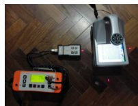
6- Georadar y detector magnético de armaduras
