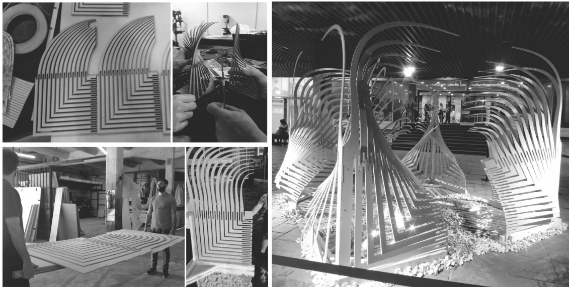
Figura 1: En la imagen se observa el proceso de diseño, la adaptación de las estrategias de corte, partiendo de muestras fabricadas con láser en MDF de 2mm para luego pasar a las placas cortadas con router CNC en MDF de 12mm. Finalmente se muestra el pabellón armado en el playón del CCSM.
