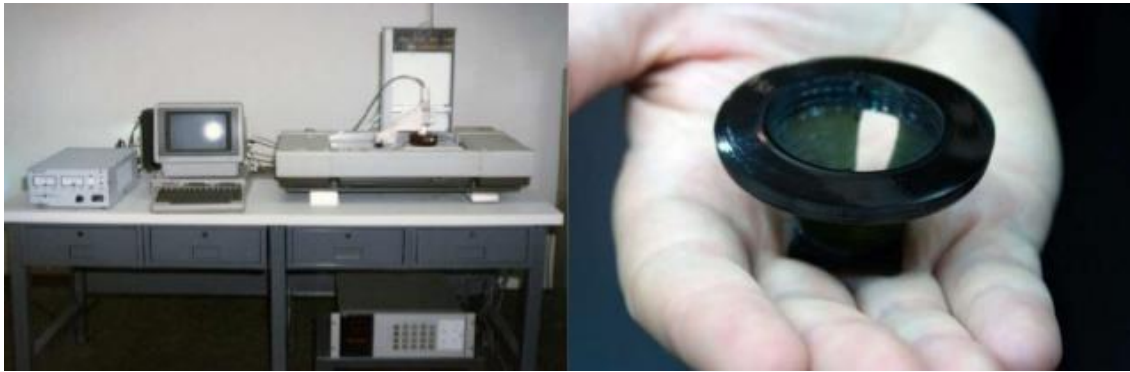
Figura 5. Primera máquina de Estereo Litografía (SLA) comercial - 3d System – USA -1984. Fuente: Wikipedia.
